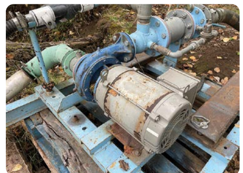
Ejemplo de una bomba de agua centrífuga. Generalmente se utiliza para bombear agua de una laguna o río.
